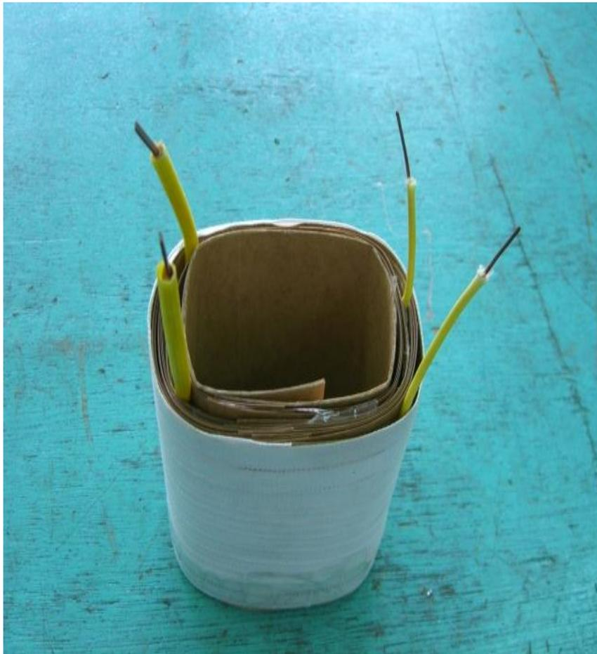
1. 將木模置於繞線機上鎖緊螺絲，用絕緣紙包上木模，再以膠帶固定。
